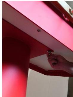
Fissare la gamba conica al tavolo utilizzando le viti e le rondelle.
