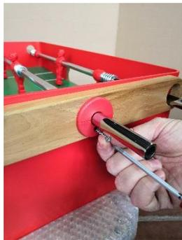
Montare le boccole nella parte esterna lasciando il foro nella parte inferiore e fissare con la vite.
