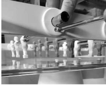
Montare le semi-boccole esterne nella parte esterna lasciando il foro nella parte inferiore e fissare con la vite.
