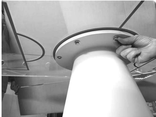
Fissare la gamba conica al tavolo utilizzando le viti e le rondelle.
