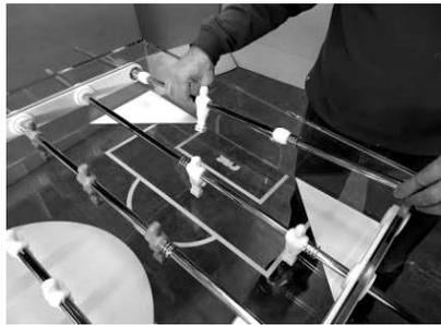
Smontare le 4 boccole premontate e infilare le aste a 1 ometto (portiere) nello stesso modo in cui sono state montate le altre aste precedentemente.
